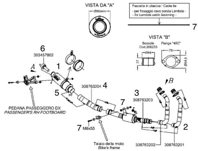
I) Componenti forniti in confezione e da utilizzare solo sulle motociclette non dotate di sonda Lambda: .Guarnizione + Tappo M18x1,5
